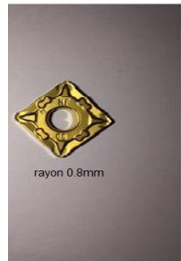
Figure II.2 Plaquettes de coupe en carbure avec revêtement PVD (GC1025)
