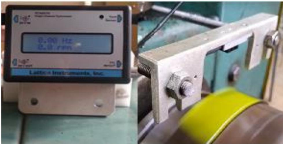
**Figure II.3:** Capteur de vitesse.
