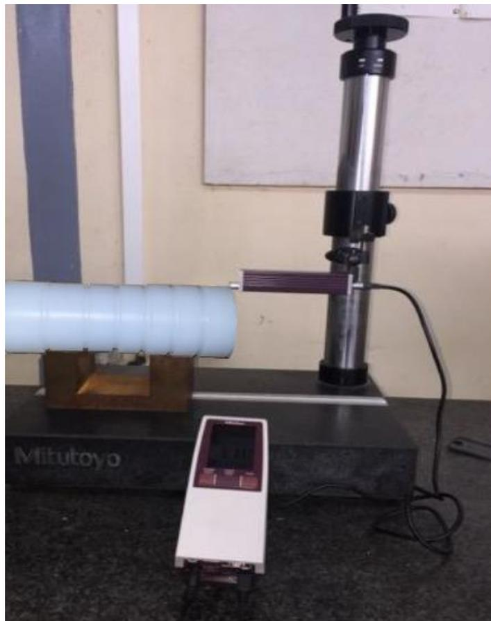
**Figure II.7:** Rugosimètre 2D.
