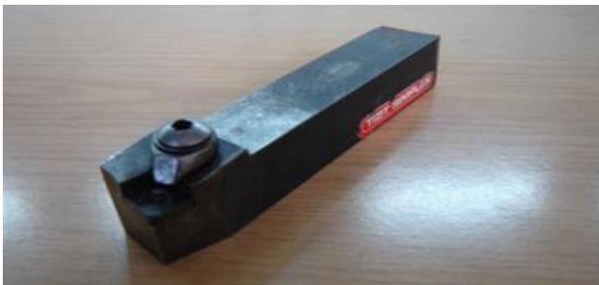
**Figure II.6:** Porte outil utilisé (CSDPN25x25M12).
