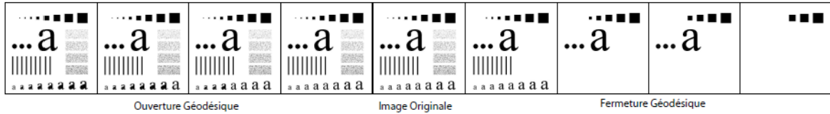
Figure 3.5: Ouvertures (vers gauche) et fermetures (vers droite) géodésiques de l'image originale (centre) en utilisant un élément structurant B circulaire de rayon [2, 4, 6, 10] pixels. [23]
