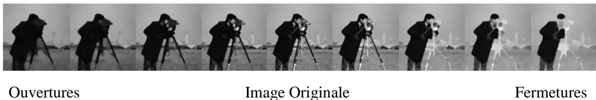
Figure 3.4 : Ouvertures (vers gauche) et fermetures (vers droite) de l'image originale (centre) en utilisant un élément structurant B circulaire de rayon [2, 4, 6, 8] pixels. [23]
