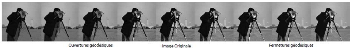
Figure 3.6: Ouvertures (vers gauche) et fermetures (vers droite) géodésiques de l'image originale (centre) en utilisant un élément structurant B circulaire de rayon [2, 4, 6, 15] pixels. [23]
