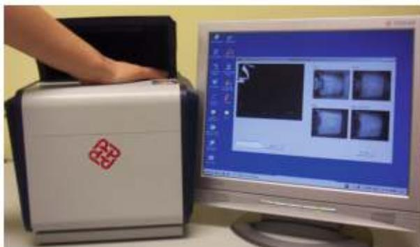
**Figure 3.3** : Prototype du système d'empreinte palmaire multispectrale
