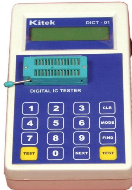
Fig. I.7. Testeur numérique IC DICT-01 [25]
