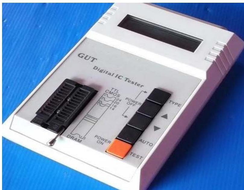
**Fig. I. 5. Testeur de circuits intégrés GUT-6000B [23]**
