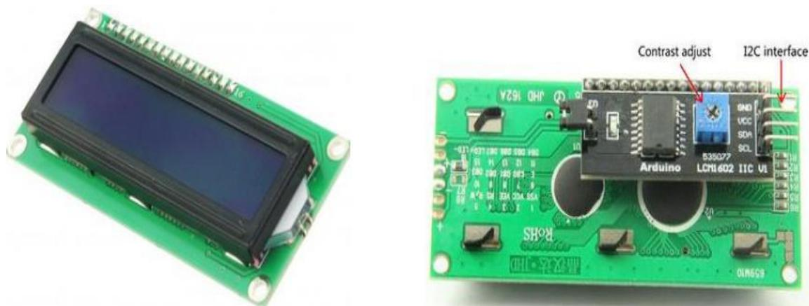
Fig. II. 17. Ecran LCD avec un I2c en arrière [19]
