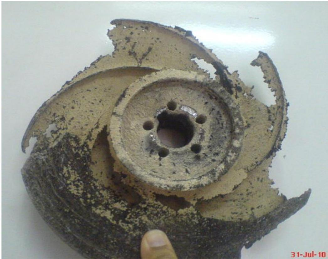
**Figure III.5 : Effet de la cavitation d'une pompe centrifuge [27].**
