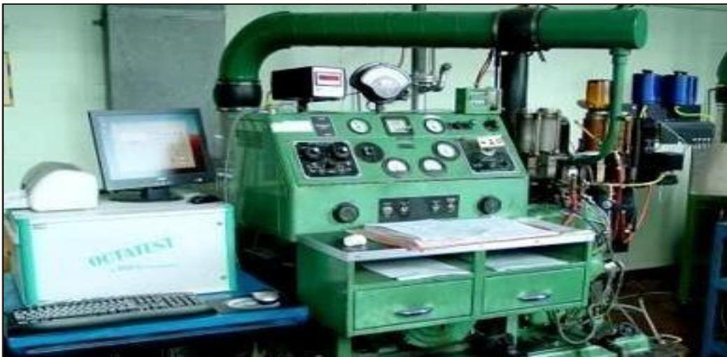
Figure IV.1: *Moteur CFR.*
