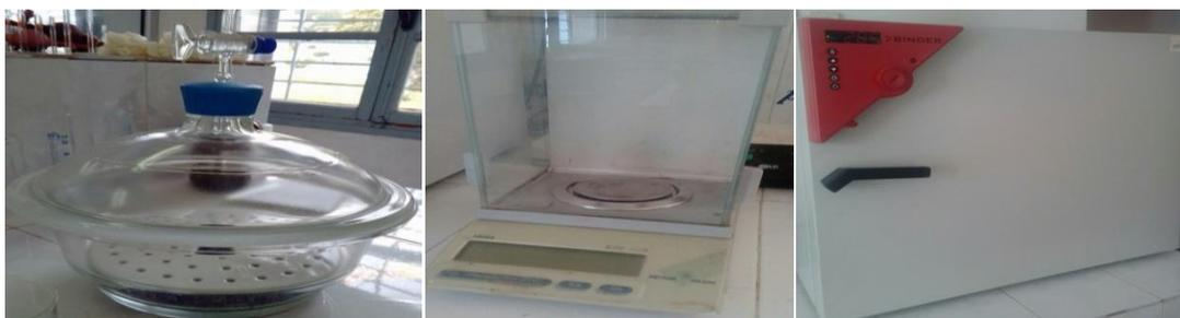
**Figure III. 15.** Image d'un dessiccateur, balance analytique, étuve utilisé lors des analyses.
