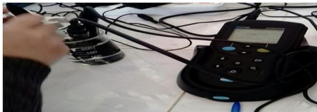
Figure III.8. Image d'un conductimètre utilisé lors des analyses.
