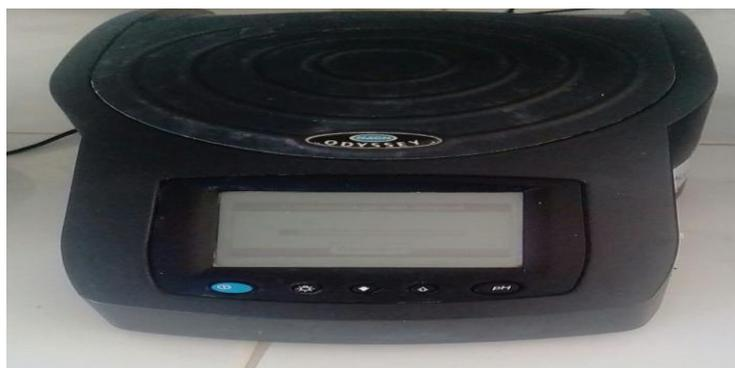
Figure III.17. Spectrophotomètre (HACH ODYSSEY).
