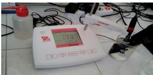
**Figure III.7.** Image d'un pH-mètre utilisé lors des analyses.
