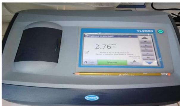
**Figure III.6.** Image d'un turbidim tre utilis  lors des analyses.
