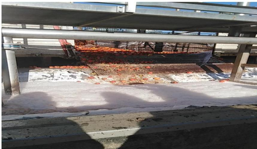
***Figure II.3: Déchargement de la matière première dans le bassin pour le lavage.***
