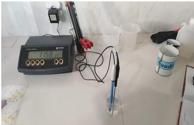
Figure III.2. Détermination de pH de l'eau.
