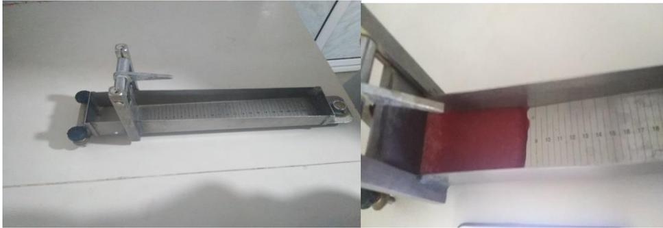
*Figure III.10 : Consistomètre utilisé au laboratoire.*
