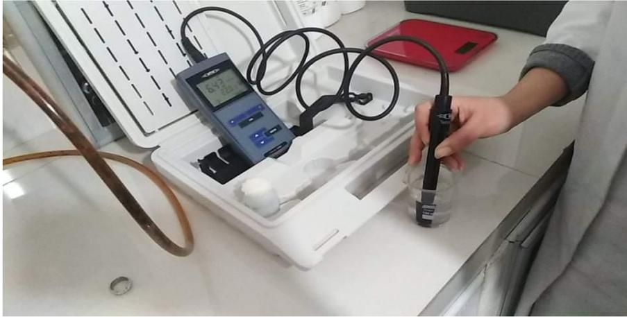
Figure III.1 : Détermination de la conductivité de l'eau.
