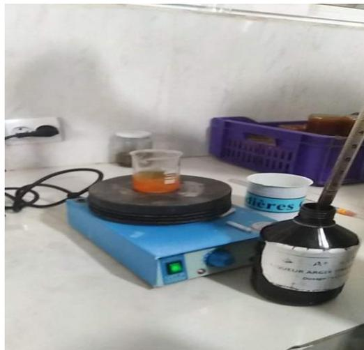
*Figure III.5 : Dosage des chlorures.*
