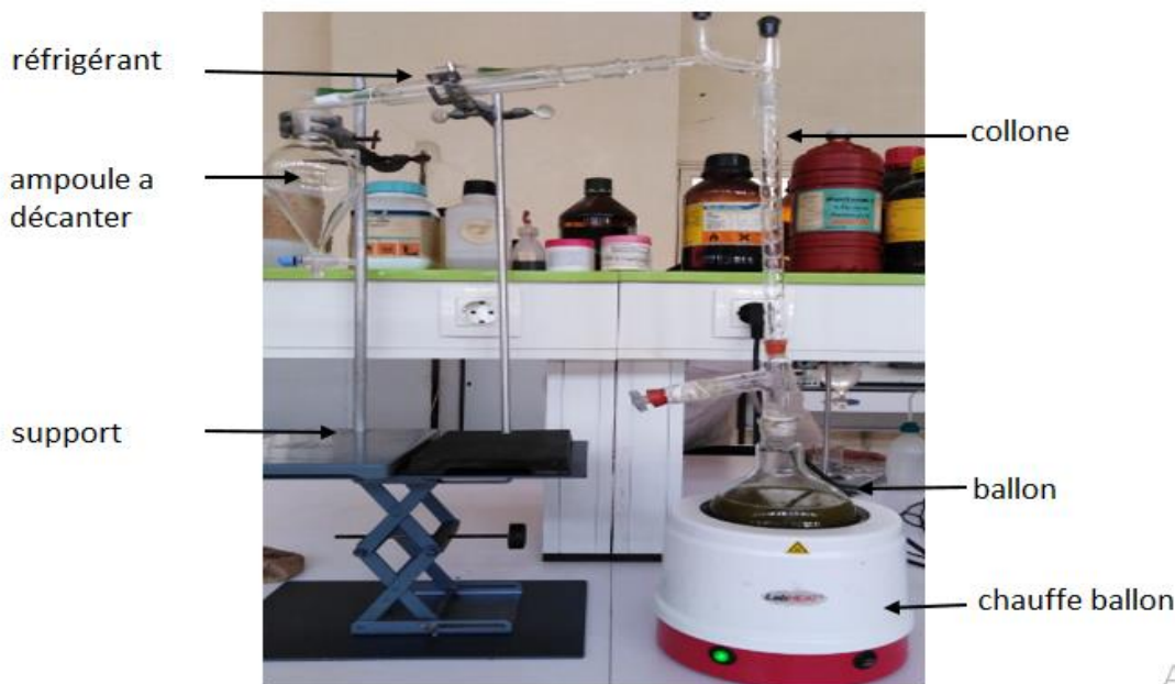
Figure III.1. : Montage de l'hydrodistillation
