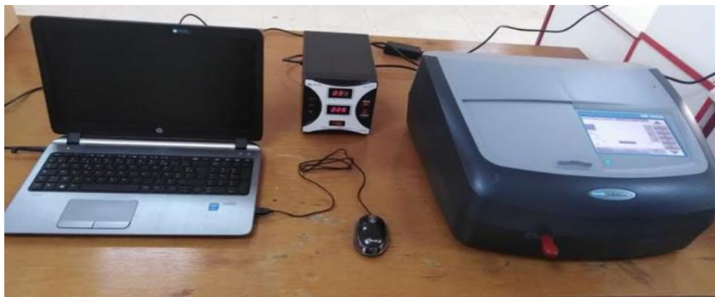
Figure III.5 : Spectrophotomètre UV-Vis de type LANGE DR 6000.
