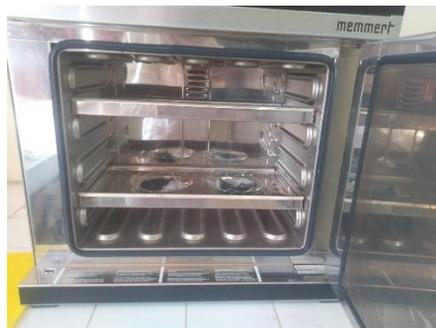
*Figure II. 4 : Photo de l'étuve utilisé pour le séchage.*
