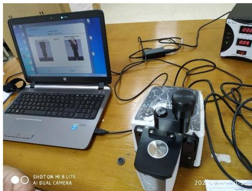
**Figure II. 8 :** Appareille la spectroscopie infrarouge à transformée de Fourier (FTIR).
