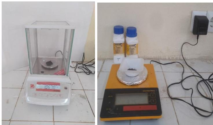
*Figure II. 6 : Photos des balances analytique et technique.*
