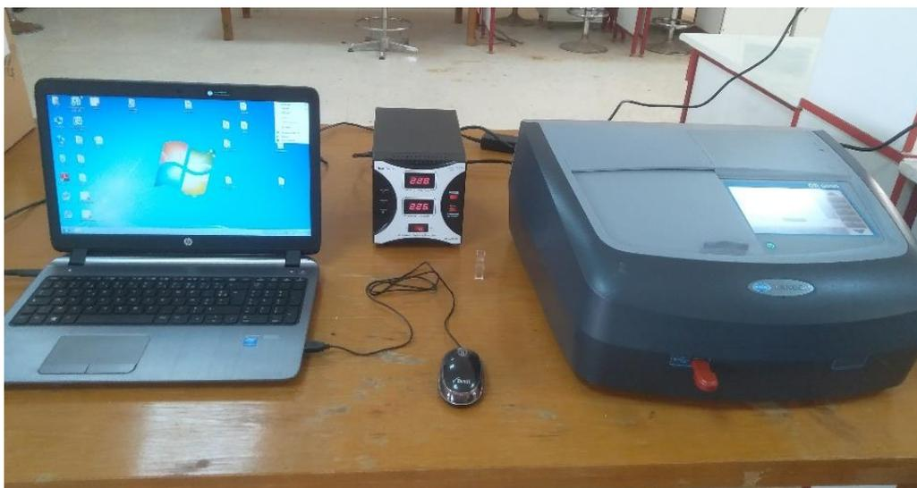
*Figure II. 11 : Spectromètre UV-Visible de type LANGE DR 6000.*
