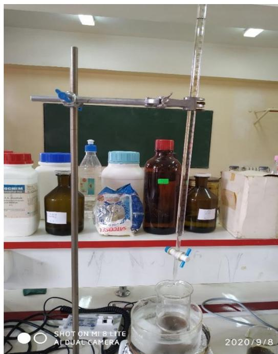
*Figure II. 3 : Montage de r duction avec l'hydrazine.*
