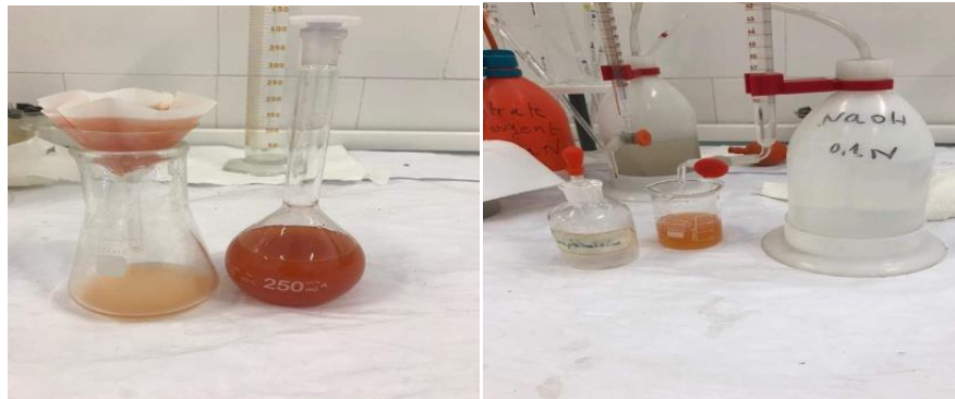
Figure II.10 Filtration et titrage avec NaOH.
