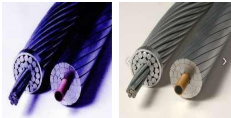
Figure I.3 : Conducteur conventionnel sur la gauche et à âme en fibre composite à droite, l'âme au centre assure les propriétés mécaniques, l'aluminium à l'extérieur les propriétés électriques du conducteur.
