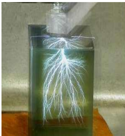
Figure III.11: Claquage d'un isolant solide « claquage dans le plexiglas entre deux électrodes pointe-plan.
