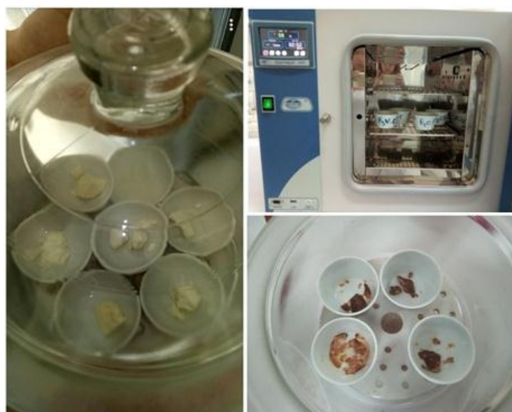
Photo 12 : Détermination de la matière sèche de fromage (Gana, A., Seridi, K., Ziar, C., 2018)
