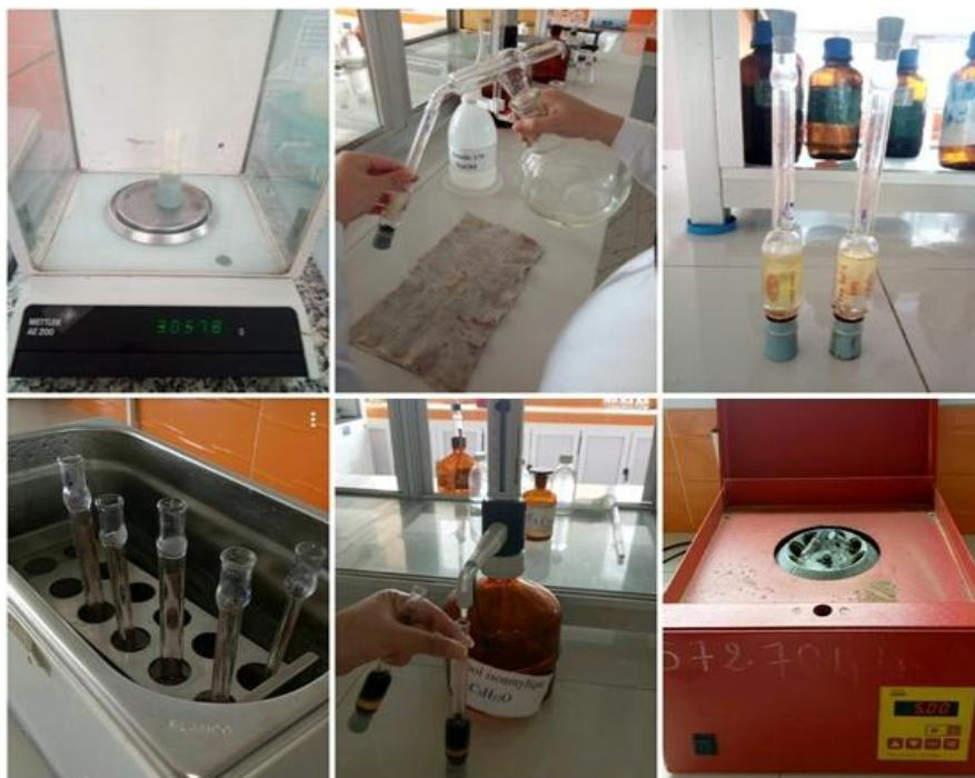
Photo 14 : Détermination de la matière grasse par la méthode Gerber(Gana, A., Seridi, K., Ziar, C., 2018)
