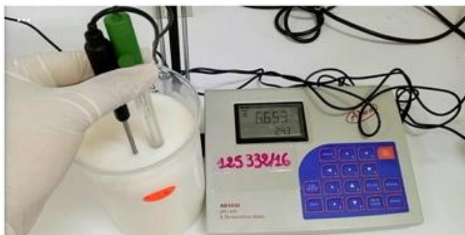
Photo 6 : Mesure du pH de lait (Gana, A., Seridi, K., Ziar, C., 2018)
