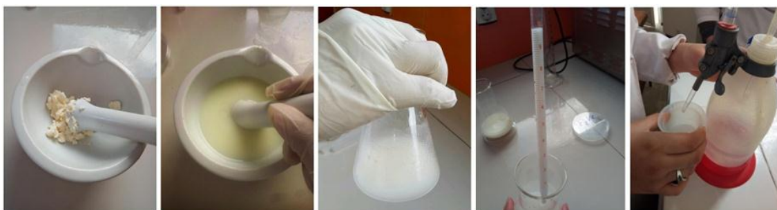
Photo 11 : Détermination de l'acidité titrable de fromage
