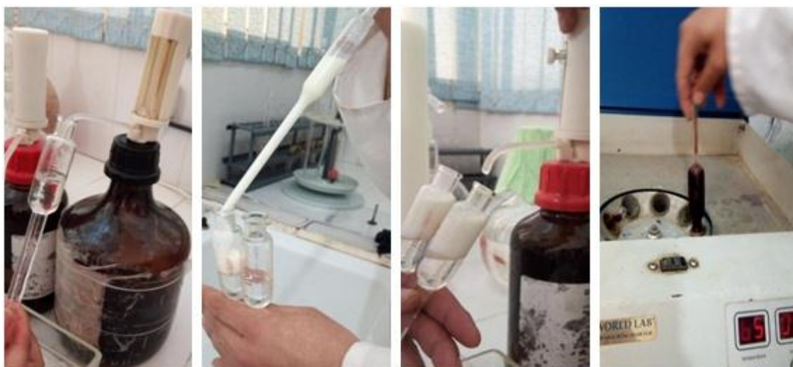
Photo 8 : Détermination de la matière grasse par la méthode Gerber de lait (Gana, A., Seridi, K., Ziar, C., 2018)
