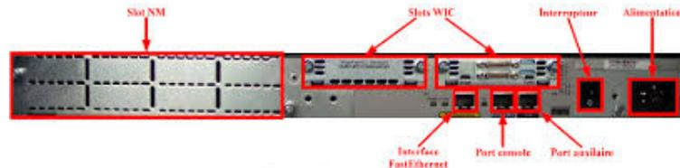
FIGURE 3.17 – Vue arrière d'un routeur cisco
