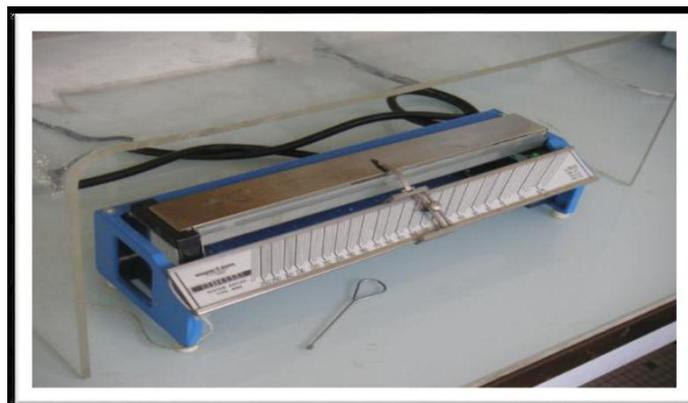
**Figure. V.3.** Appareil de Banc Kofler
