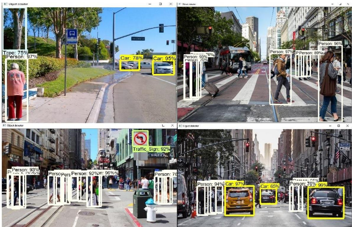
Figure 3.7 Résultats de détection de Faster RCNN.
