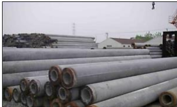
Figure I.11 : pieux en béton. (Mouffok M., 2013 ., p82)
