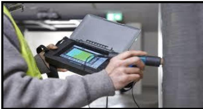
Figure IV- 6 : Mesure du potentiel de corrosion.
