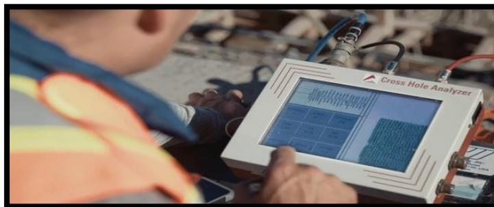
**Figure IV- 1 :** Auscultation sonore du béton.
