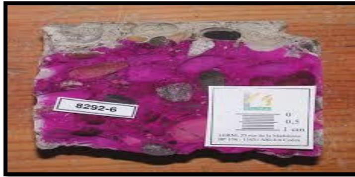
Figure IV- 3 : Teste à la carbonatation.
