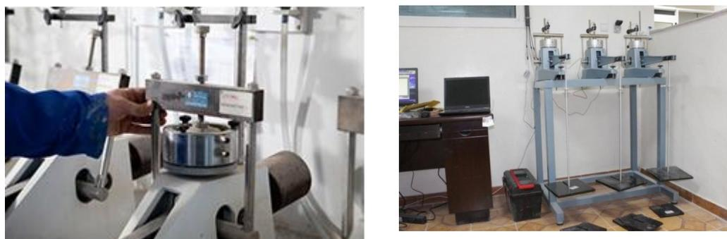
**Figure 4.1** : L'essai de gonflement à l'oedomètre
