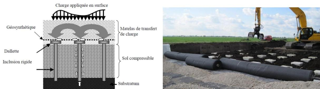
*Figure 58 : Principe de fonctionnement des inclusions rigides*
