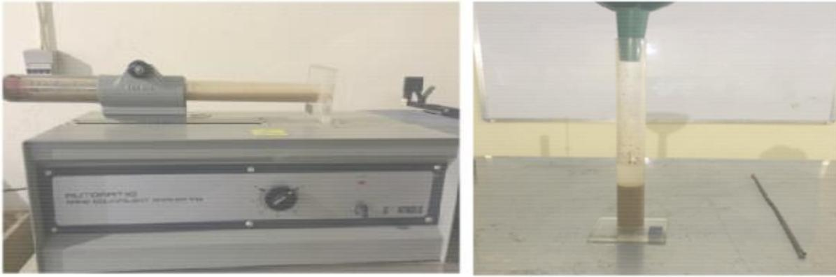
*Figure 23 : Essai équivalent de sable*
