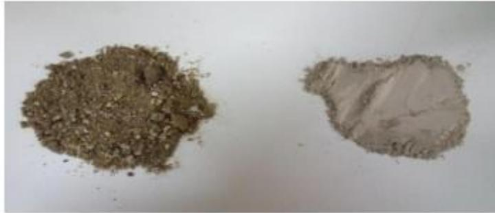
*Figure 74 : Le laitier granulé avant et après broyage*
