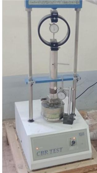
*Figure 79 : Photo de la machine CBR au cours de compactage*
