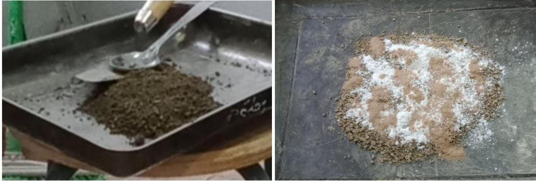
*Figure 78 : Préparation des mélanges pour le compactage*
