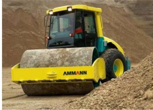
*Figure 41 : Compacteur vibrant monocylindre lisse*
