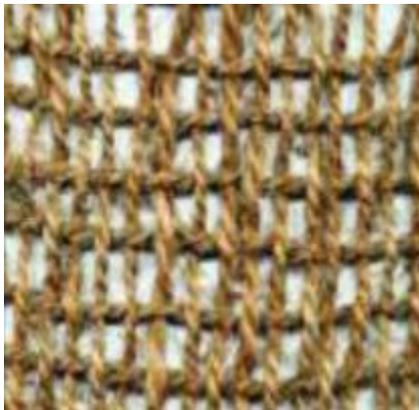
*Figure 62 : Géotextile tricoté*
