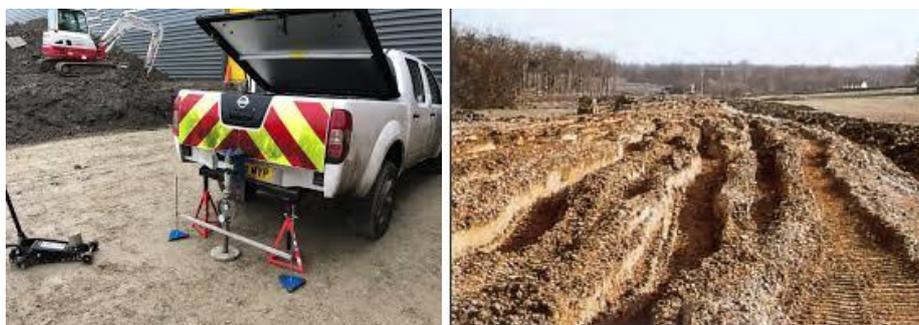
*Figure 34 : Photos de l'essai IPI in situ et mesure de la profondeur d'ornièrage*
