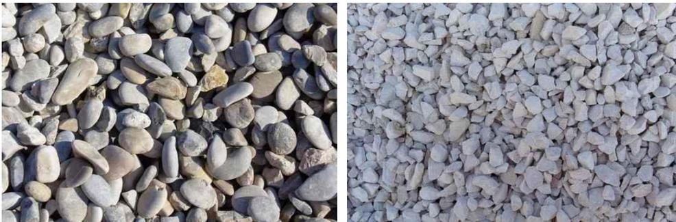
*Figure 10: Photos des gravillons roulés (à gauche) et concassés (à droite)*
