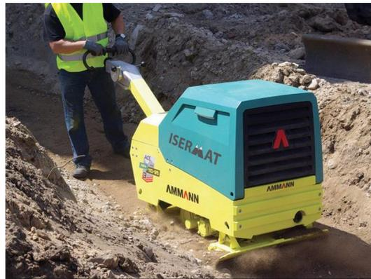
Figure 46 : Plaque vibrante PQ1
