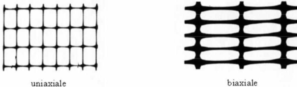
*Figure 63 : Géogrilles uniaxiale et biaxiale*
