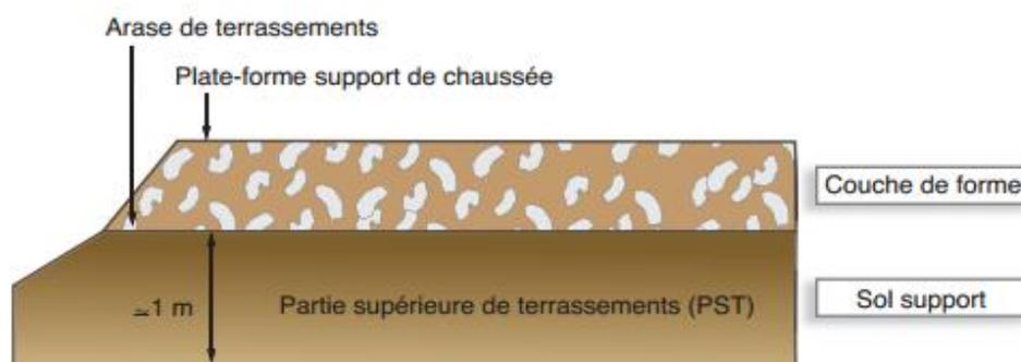
Figure 47 : coupe type d'une plate-forme support de chaussée
