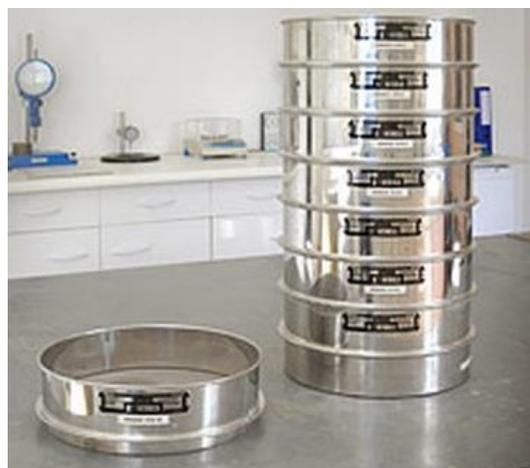
*Figure 19: Analyse granulométrique par tamisage*
