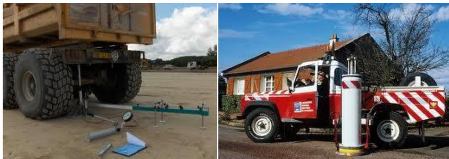
*Figure 33 : Photos de l'essai à la plaque et à la dynaplaque*
