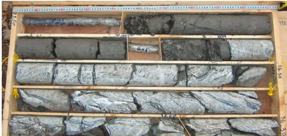
*Figure 16: Photo de l'état des carottes après extraction du forage*
