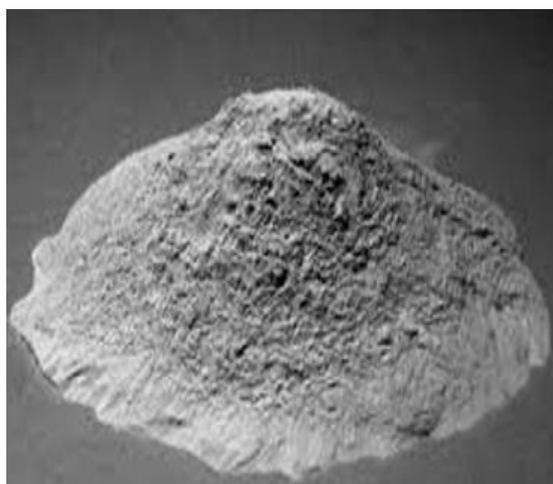
*Figure II.9. Photo de la cendre volante.*
