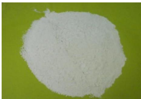
*Figure III.1. Filler calcaire [1].*
