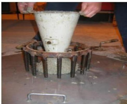
*Figure I.9. Essai d'étalement*
