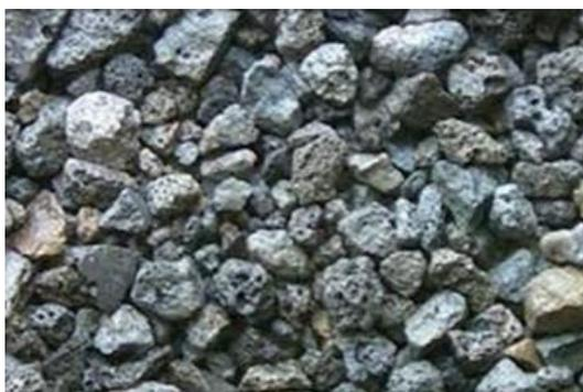
*Figure II.7. Photo d'un laitier de haut fourneau.*
