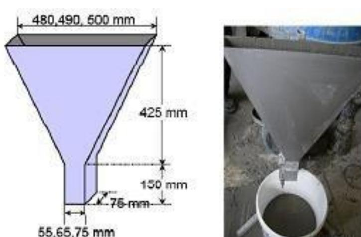
**Figure I.7.** Essais des Entonnoirs [14].
