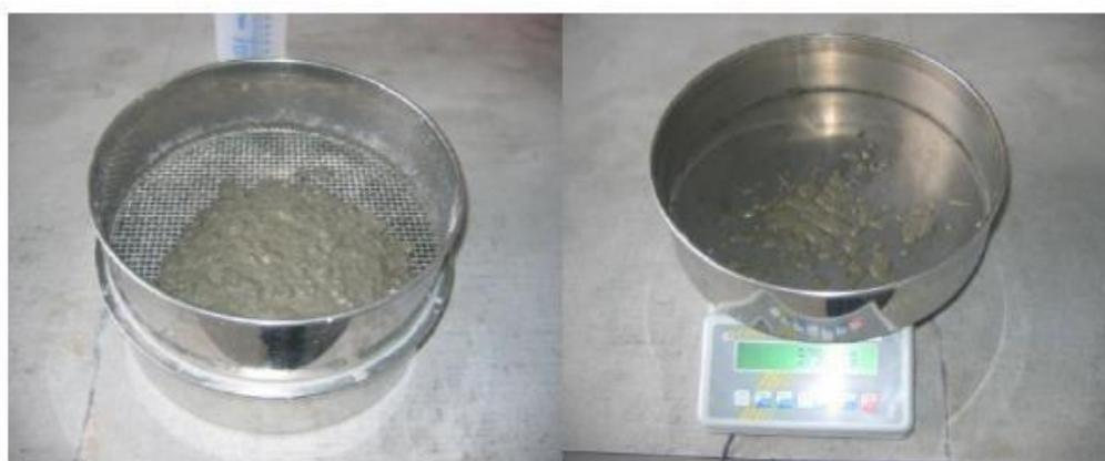
*Figure 1.11. Essai au tamis [17].*
