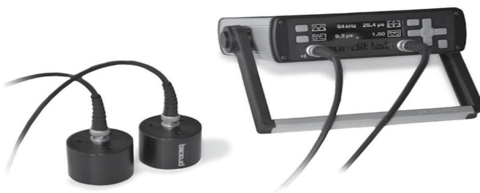
**Figure 1.13 :** Appareil d'auscultation sonore punditLab [22]
