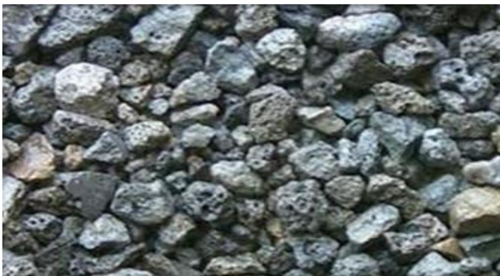
**Figure 2.24:** Laitier de haut fourneau.
