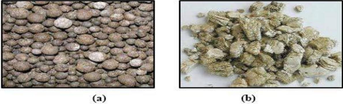
**Figure 1.7 :** Granulats expansés : (a)Bille d'argile expansé; (b) Schiste expansé
