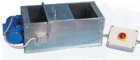
**Figure 1.10** : Maniabilimètre LCPC.
