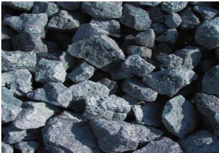
**Figure 2.23:** Laitier d'acier.
