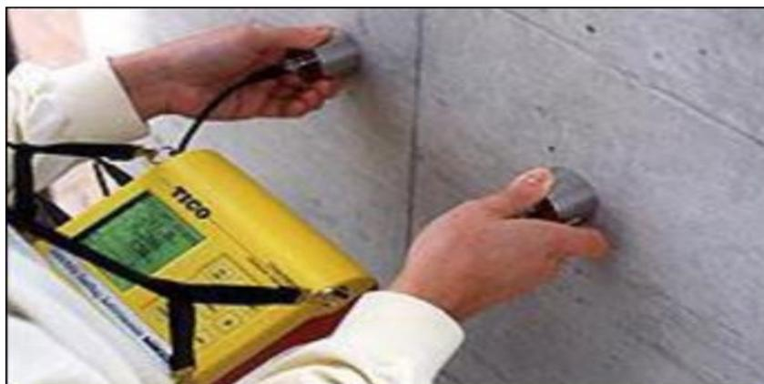
**Figure 1.12 :** Appareil d'auscultation sonore.
