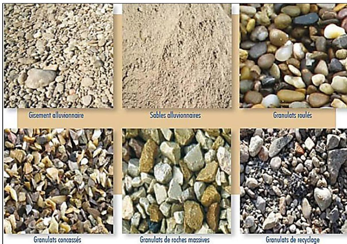
**Figure 1.6 :** Exemples de granulats d'origines différentes [5]
