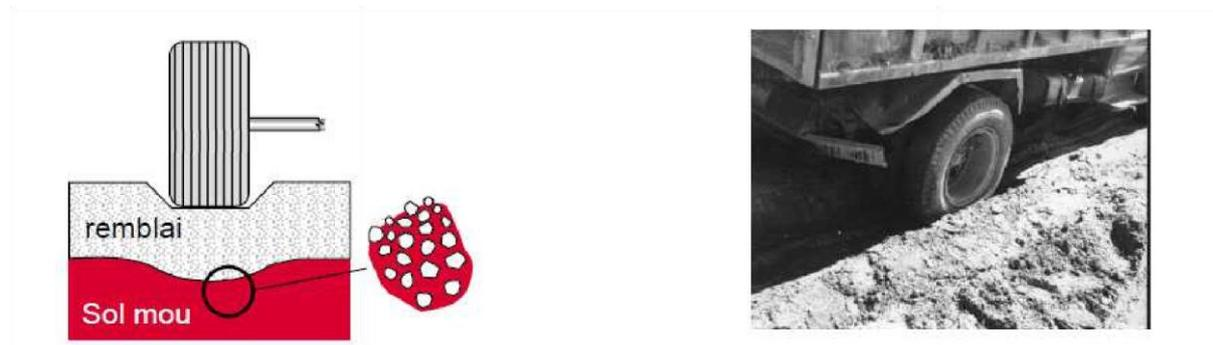
**Figure II.26.** Mécanismes typiques de dégradation des routes non revêtues et non renforcées sur les sols mous.
