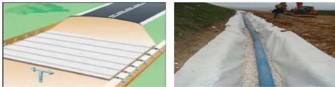
**Figure II.21.** L'utilisation des géotextiles pour le drainage.
