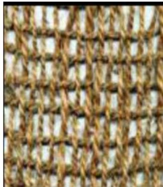
**Figure II.4.** Géotextile tricoté.
