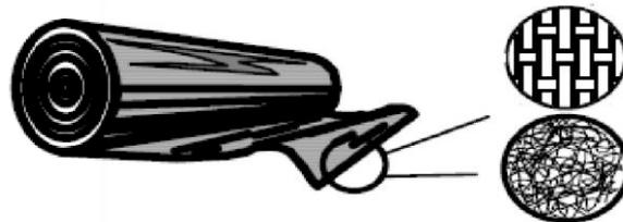
**Figure II.1.** Les Géotextiles.
