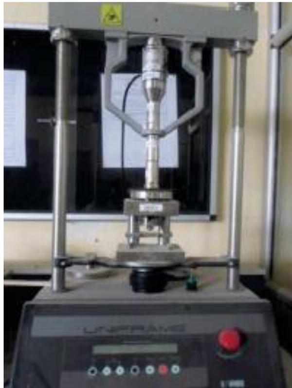
Figure III. 17. Machine d'essai à la traction par flexion
