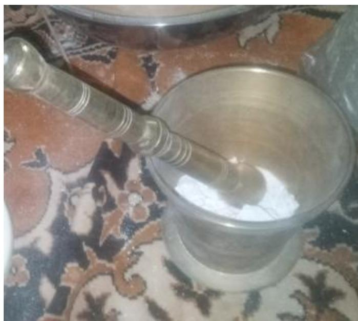
Figure III.2. Opérations de broyage manuel de l'argile
