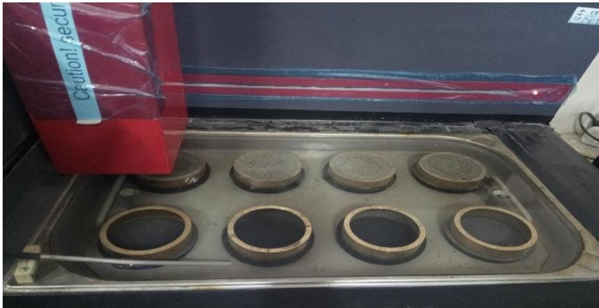
Figure III. 12. l'appareil de Vicat pour calcul Prise des ciments
