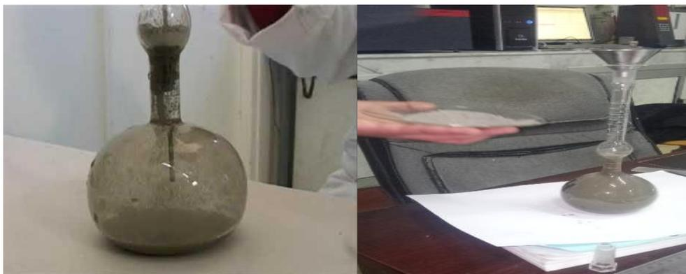
Figure III. 10. mesure de la masse volumique absolue des ciments
