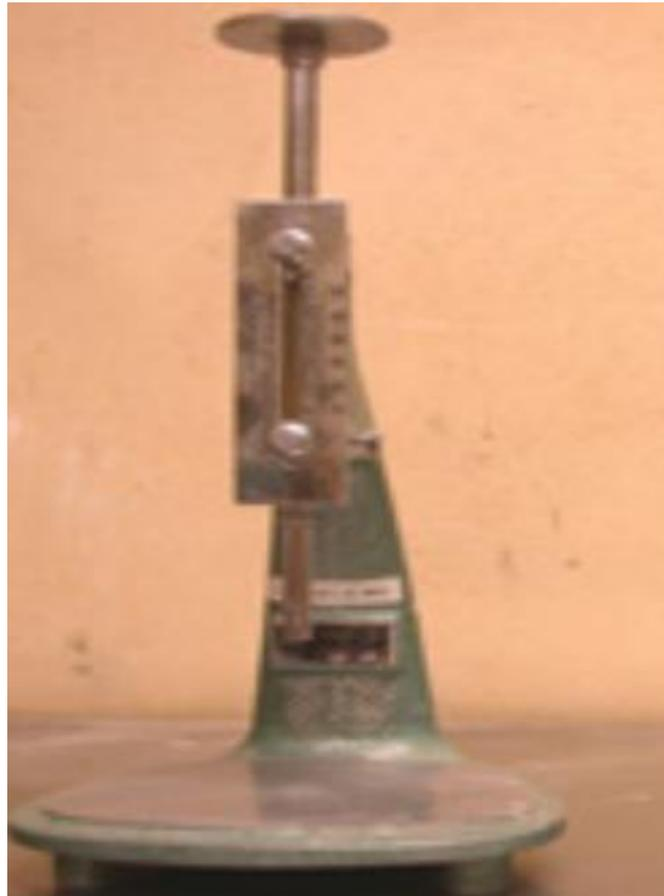
Figure III. 11. appareil de Vicat pour calcul la Consistance normale des ciments
