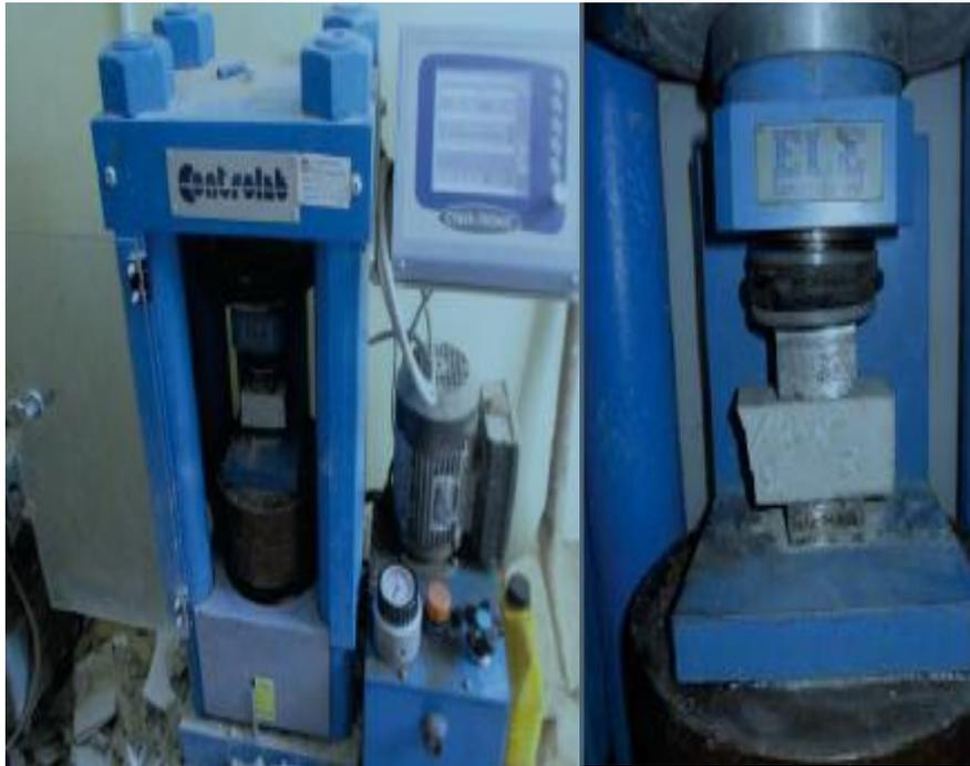
Figure III. 18. Machine d'écrasement
