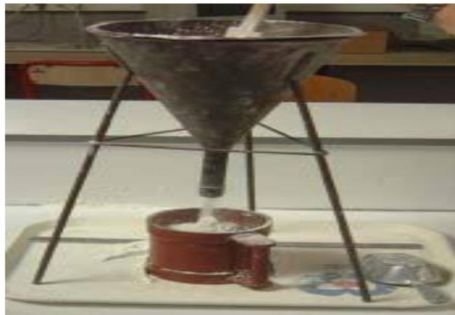
Figure III. 9. Mesure de la masse volumique apparente des ciments
