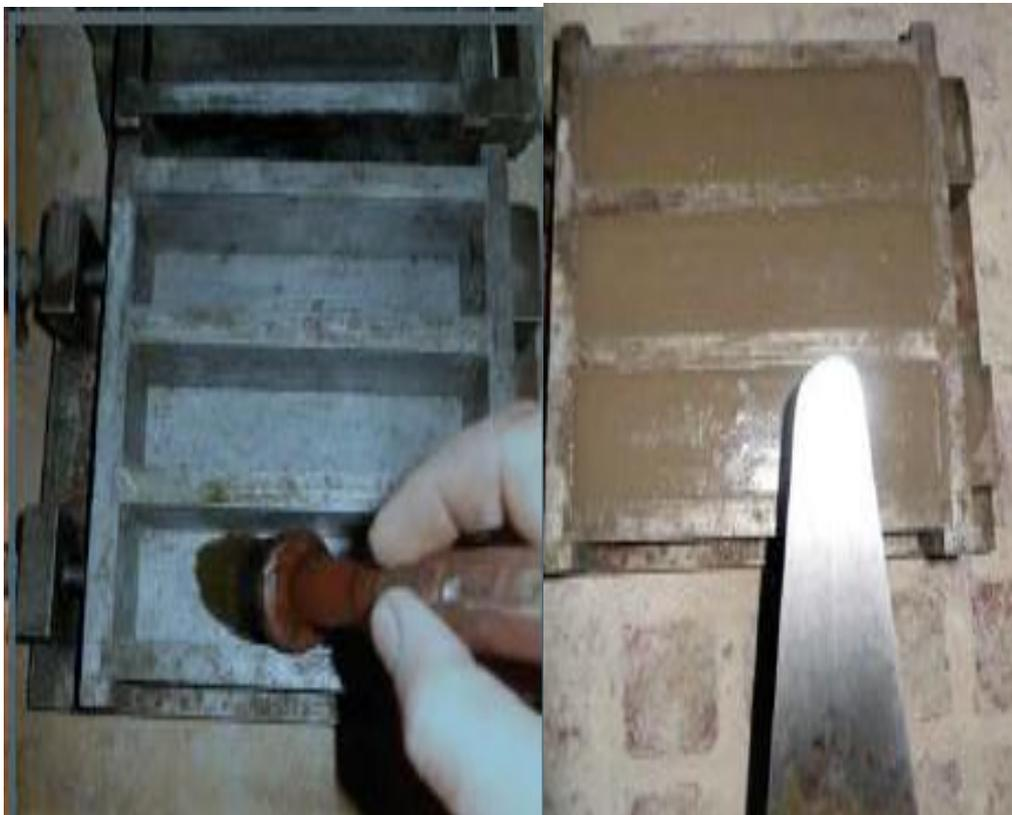
Figure III. 15. préparation des éprouvettes
