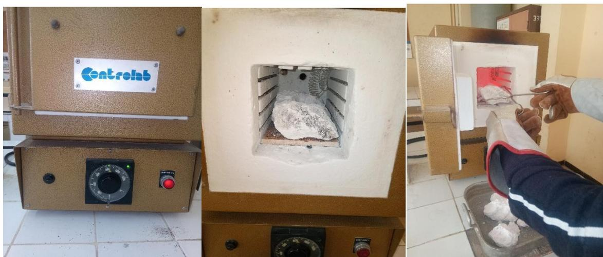
Figure III.1. Calcination de l'argile
