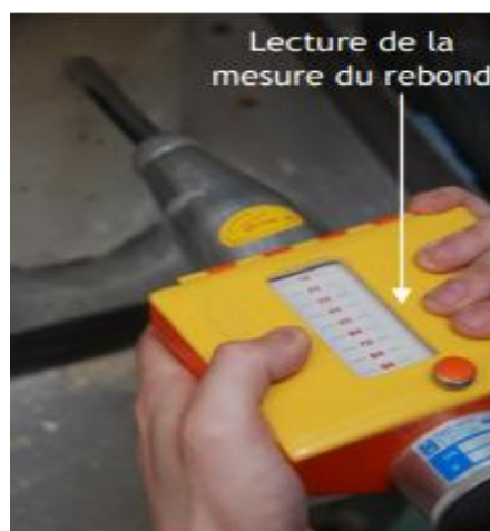
Figure II.22 : Essai de dureté à l'aide du scléromètre
