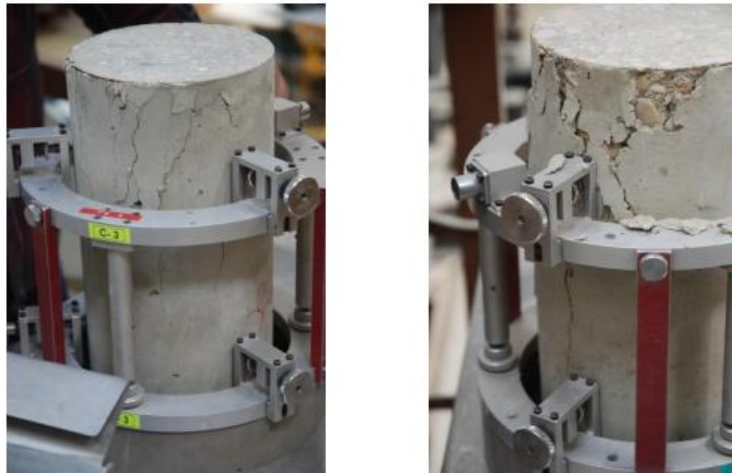
FigureII.20 : Éprouvettes après essais encore équipées de la cage extensométrique
