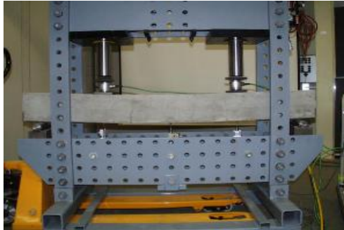
FigureII.21 : l'essai de flexion a l'état durci
