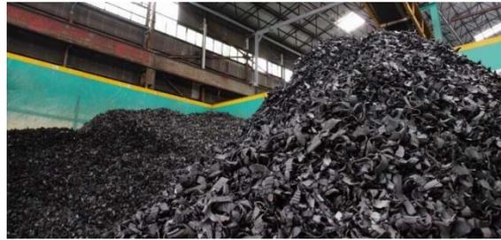
*Figure II.15 Chips de pneus [13].*
