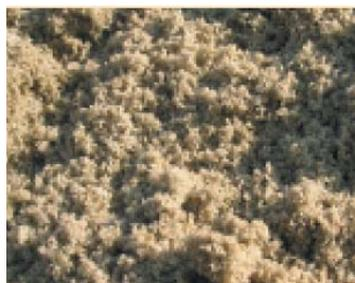
*Figure II.35 Laitier de Haut-Fourneau Vitrifié (granulé ou bouleté).*
