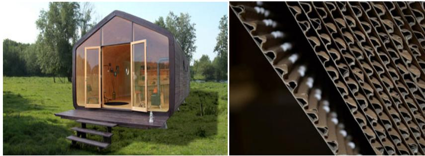
**Figure II.22** *Maison construite avec des plaques de carton ondulé [45].*
