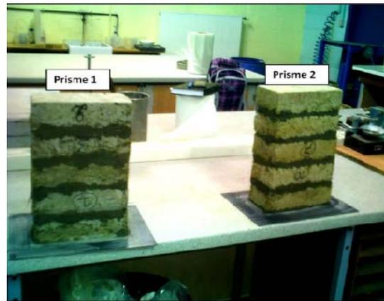
**Figure II.44** Prismes confectionnés avec des briques de fibres diss [30].
