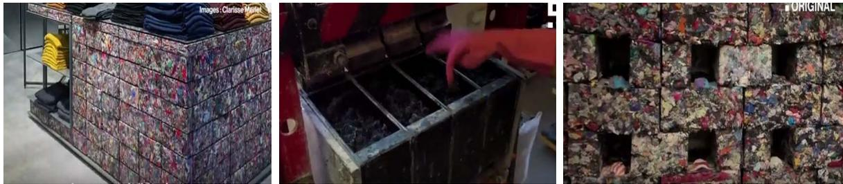
*Figure II.30 Briques en textile recyclés.*
