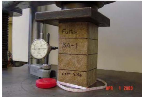
Figure III.24 Configuration des essais de compression uniaxiale[14] .
