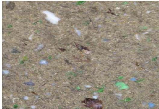
*Figure III.2 Composite de déchets plastiques compactés sable-PET.*
