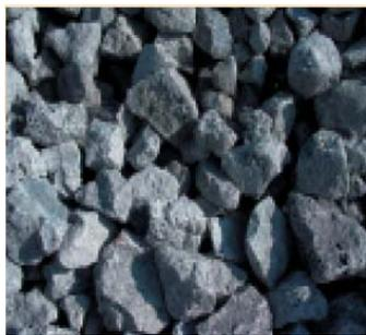
*Figure II.36 Laitier d'Acierie de Conversion (LAC en français, BOF slag en anglais).*
