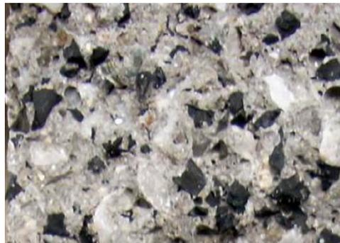
**Figure II.18** Béton à base de granulats de caoutchouc [24].
