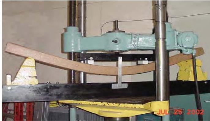
**Figure III.26** Photo de l'essai de flexion sur quatre points en cours [14].
