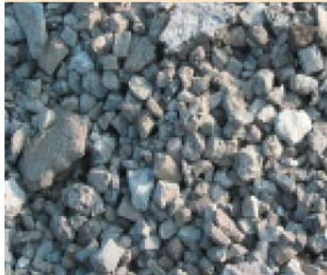
*Figure II.34 Laitier de Haut-Fourneau Cristallisé [53].*
