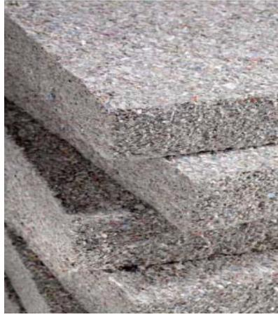
**Figure II.21** *Panneau compacté de ouate de cellulose papier [46].*
