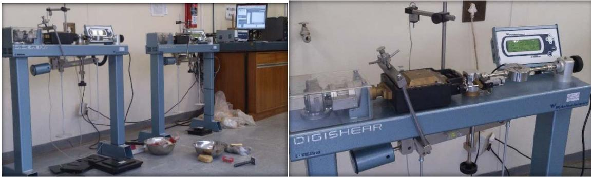
**Figure III.3** Appareil Digishear utilisé pendant l'essai.
