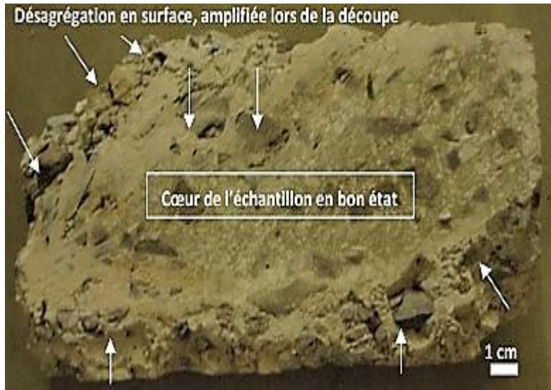
Photo IV.4 : Coupe d'un échantillon après 200 cycles de gel/dégel - baisse de 50% d'UPV [Boukari, 2011].
