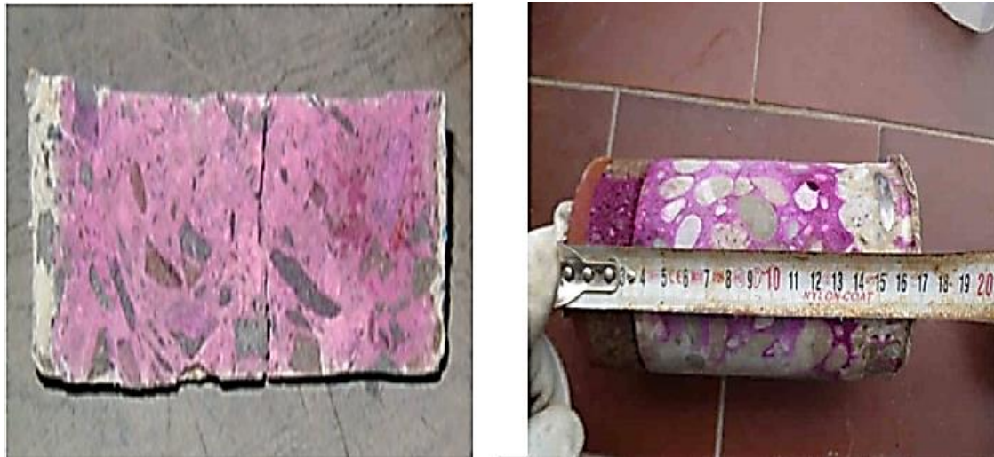
Photo II.3 : Phénomène de carbonatation [Itmaizeh 2016].
