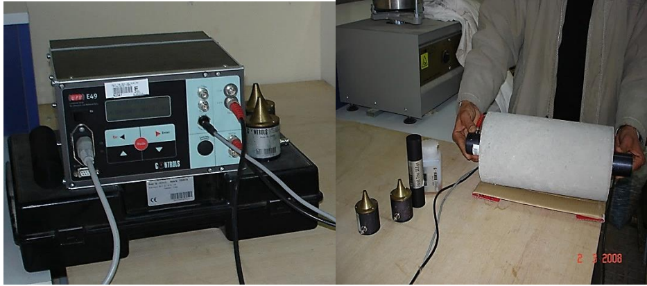
Photo III.1 : Equipement à ultrasons [Benouis et Grini 2011].
