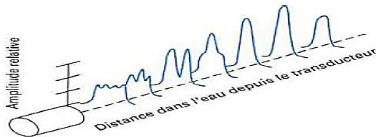
Figure III.10 : Distribution de l'amplitude du faisceau ultrasonore [Marzouki et al. 2006].
