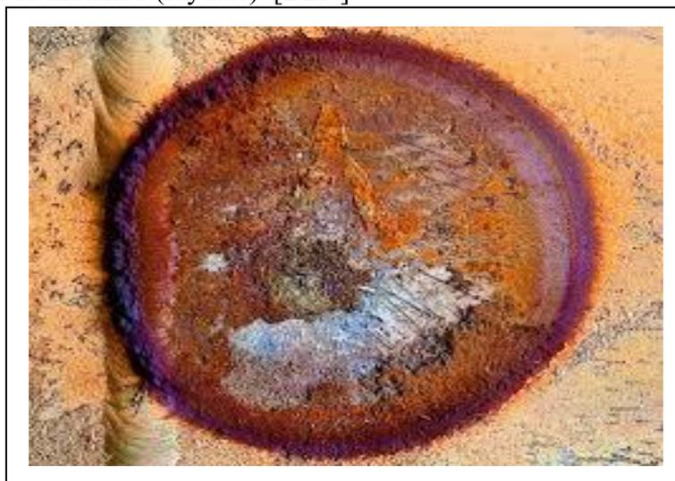
**Figure 2.16 :** Corrosion par piqure [BEN].
