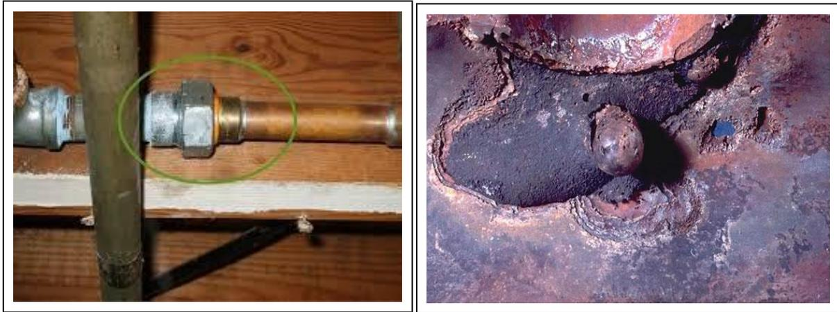
**Figure 2.20 :** Corrosion galvanique [AFGC 03].
