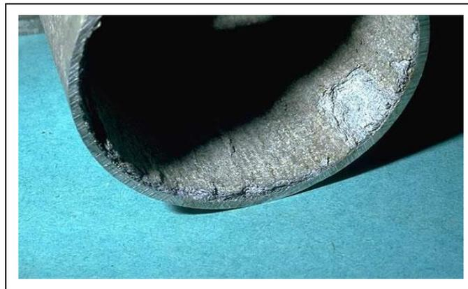
**Figure 2.21 :** Corrosion sélective [AFGC 03].
