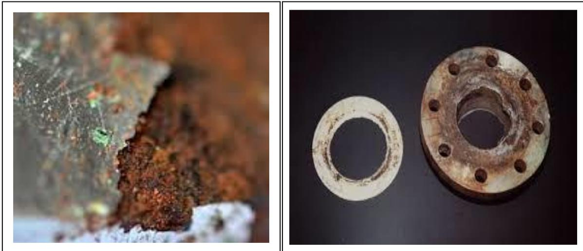
**Figure 2.18:** Corrosion par crevasses [AFGC 03].
