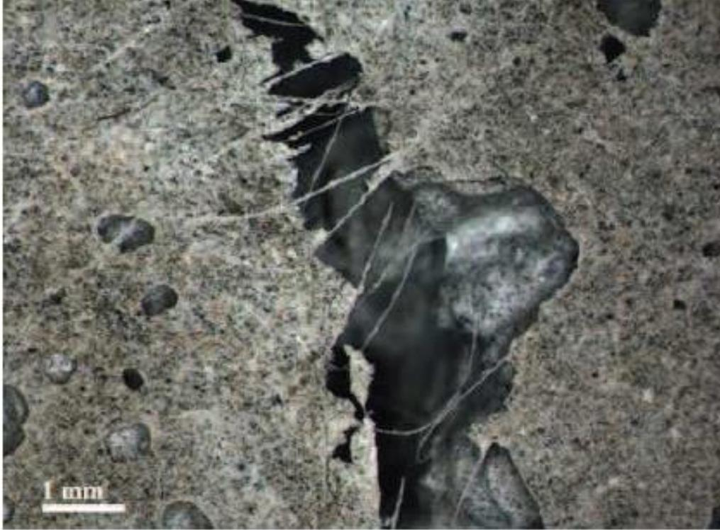
**Figure 4.6 :** Pontage par les fibres des fissures dues aux retraits [MAL 11].
