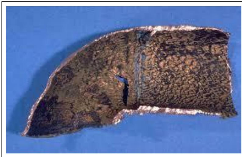
Figure 2.19 : Corrosion par érosion [AFGC 03].
