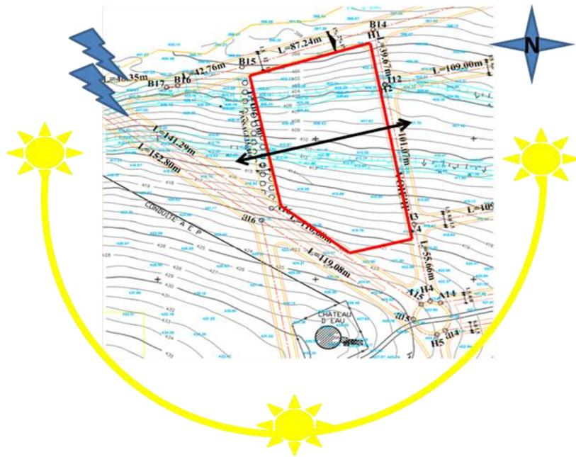
Figure 95: l'ensoleillement et les vents dominants dans le terrain
