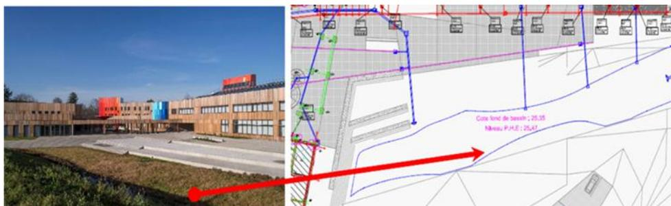
Figure 38: zone de récupération des eaux pluviales derrière les blocs d'enseignement
