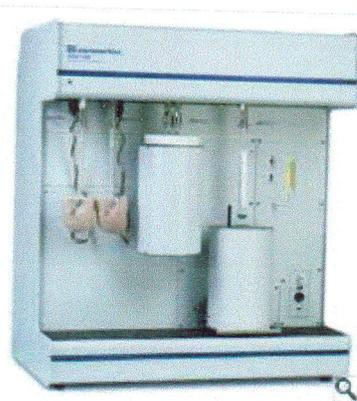
**Figure 10** : appareil de Réduction en Température Programmée (TPR)
