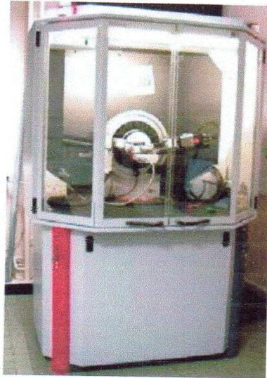
**Figure 8:** Diffractomètre de marque BRUKER - AXS type D8
