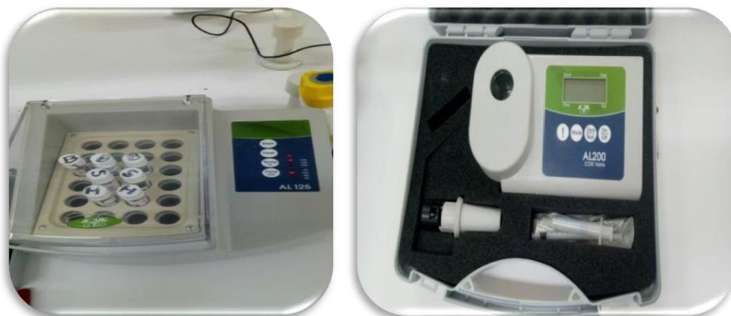
Figure 9 : Réacteur à gauche et photomètre de mesure à droite
