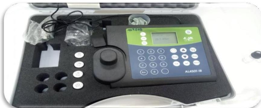
Figure 7: turbidimètre de type AL450T-IR
